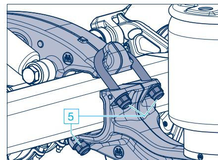
**Примечание:** Запрещено выполнять сварочные работы на направляющем рычаге и держателе пневматической рессоры!
