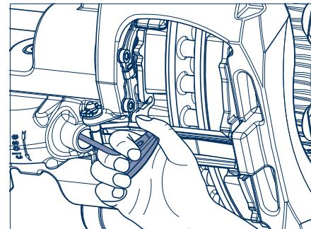
Проверить направляющие суппорта дискового тормозного механизма:
