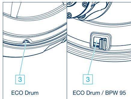
При наличии индикаторов износа тормозных накладок критическое состояние тормозных накладок обычно сигнализируется горизонтальным положением рычага (когда тормоз отпущен).
