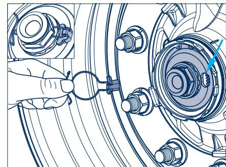
7. Смазать колпак на участке байонетного затвора, а также поверхность, к которой будет прилегать уплотнительное кольцо круглого сечения, тонким слоем специальной долговременной смазки BPW ECO-Li<sup>plus</sup>.
