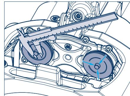
Вывернуть упоры посредством регулятора зазора (мин. 30 мм) так, чтобы грязезащитные уплотнения были отчетливо видны.
