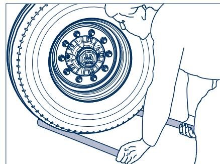
**При ощутимом зазоре в подшипниках системы ECO Plus 3:**
