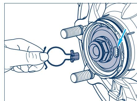
Снять пружинное кольцо с отогнутыми концами вместе со стопорным клином с осевого болта.
