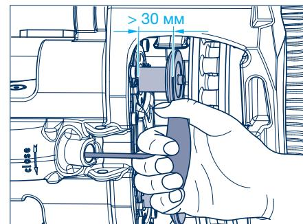
**Проверить плотность посадки. (Осмотр, см. детальный рисунок)**
