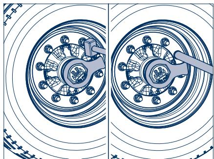
**Колпаки на осях ECO Plus 2 оснащены байонетным затвором. Проверить плотность посадки посредством осмотра.**
