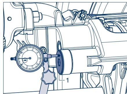
Точная проверка зазора при демонтированных колесах:
