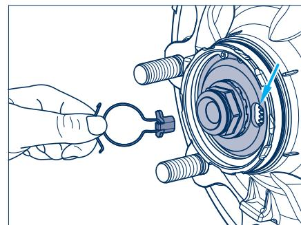
Установить пружинное кольцо с отогнутыми концами в паз шестигранника осевого болта.
