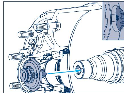
Затягивать осевой болт (размер 46) и одновременно и непрерывно поворачивать ступичную систему ECO. Прежде чем проскочит зубчатое зацепление осевого болта (сработает ограничитель момента затяжки), нужно сделать несколько оборотов.
