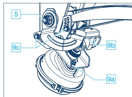
Двустороннее устройство подъема оси, привинчиваемое
