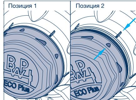
3. Затягивать осевой болт и одновременно и непрерывно поворачивать систему ECO с помощью шестигранного ключа (размер 46). Прежде чем проскочит зубчатое зацепление осевого болта (сработает ограничитель момента затяжки), нужно сделать несколько оборотов.
